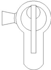
Die Schließnase des Profilhalbzylinders muss vor dem Einbau auf 90 ° bei Schlüsselabzug eingestellt werden!
